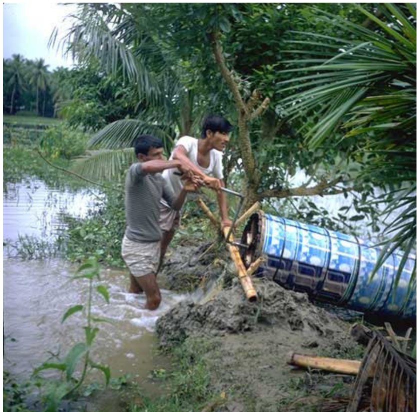
Figura 1: sollevamento delle acque nel terzo mondo tramite Clochea (vite di Archimede) (archivio Dr. T.Schioler)
